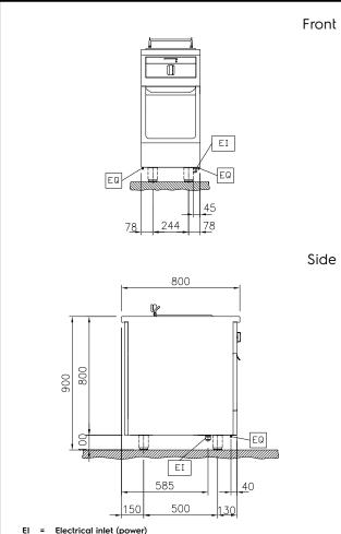
Electrical inlet (power) EQ **Equipotential screw**
